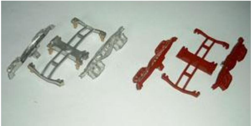
Die Drehgestelle werden lackiert und zusammengebaut.
